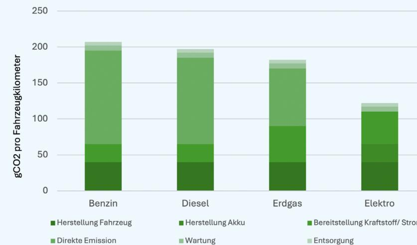
Abb.: CO<sub>2</sub>-Emission verschiedener Fahrzeugtypen [UBA 2020]
